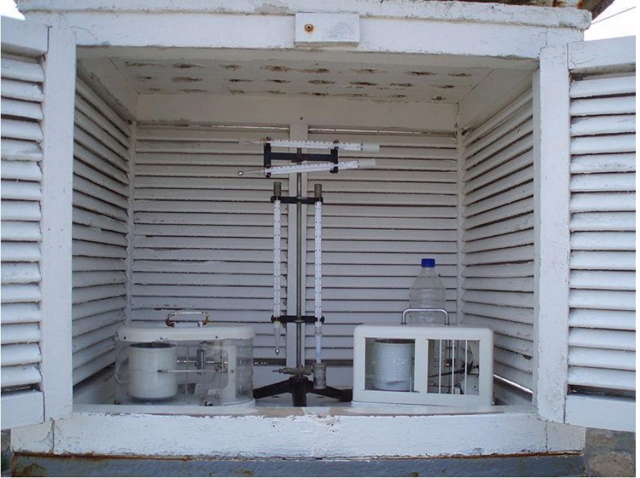
Interno di una capannina meteorologica*
